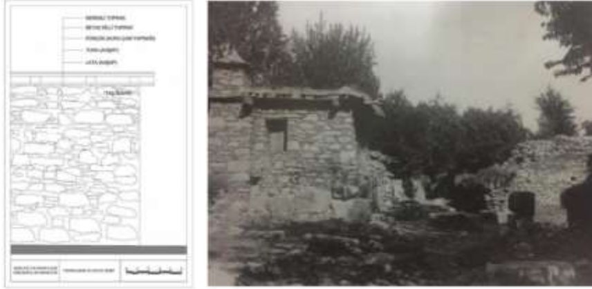
Şekil 18. Toprak damlı ev detay çizimi (Aladağ, 2004, kaynağında yer alan ifadeler doğrultusunda detay çizimi yapılmıştır) (Kökcü, 2024)
